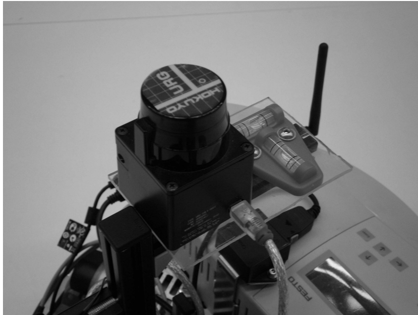
Abbildung 3.9.: Befestigung des Laserscanners auf dem Robotino ®
